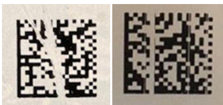
Нарушение целостности КМ*
